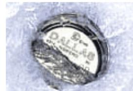
Необходимо отметить, что при организации процедуры считывания информации, накопленной устройством ТЕРМОХРОН, эксплуатировавшимся во влажной среде, непосредственно перед его подключением к какому-либо зонду или приемнику "таблеток" средства обслуживания следует, во избежание закорачивания контактов 1-Wire-магистрала, тщательно удалить с корпуса регистратора остатки влаги или солевого налёта.
