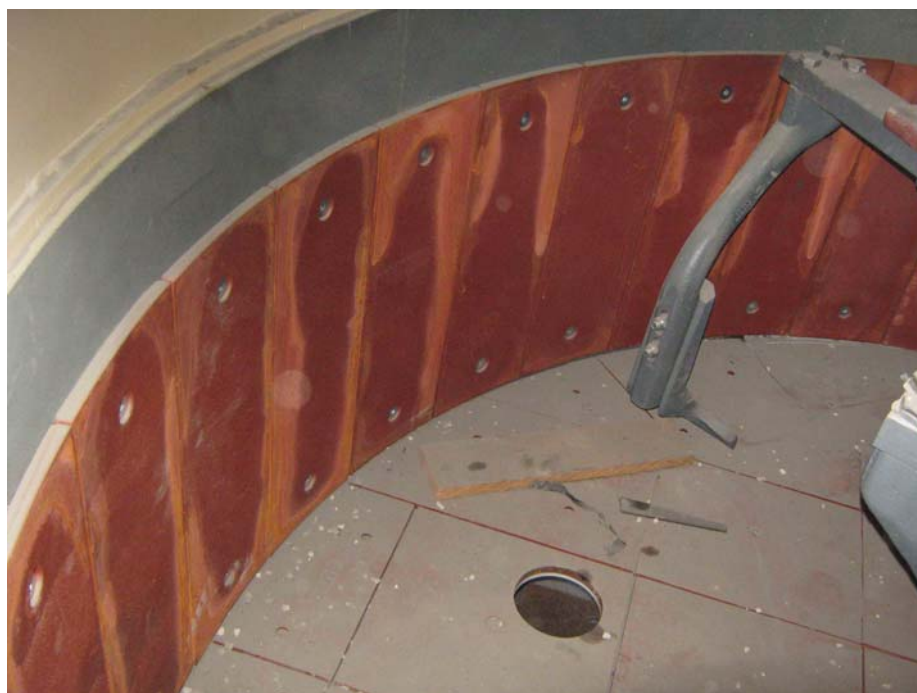
Пример выполнения отверстия в полу планетарного бетоносмесителя
