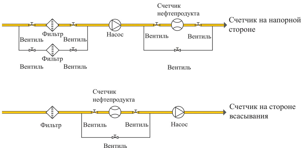
Если счетчик устанавливается на стороне всасывания насоса необходимо учитывать максимальную потерю давления при максимально допустимом потоке и возможной максимальной вязкости топлива. При этом следует также учитывать и установленные фильтры.
