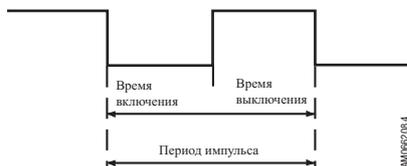
Длительность импульса, а также длительность включения и выключения рассчитываются по следующим формулам:
