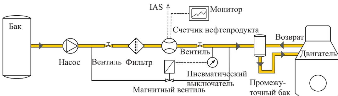
В промежуточном баке управление поплавками или клапанами. Следует избегать образование газа. Перепускной клапан (магнитный клапан) открывается, когда давление падает ниже установленного значения. Если двигателей несколько, для каждого из них требуется своя полная установка.
